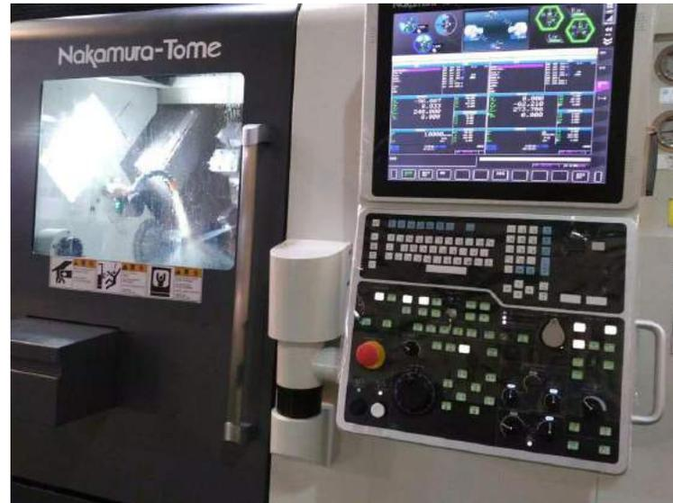
双主轴双刀塔带Y轴功能，强大复杂零件制造能力，中村留高端机床是刀塔机中的王牌！史特牢是较早购买此款机器的工厂！高端设备的引进让企业更具竞争力！
